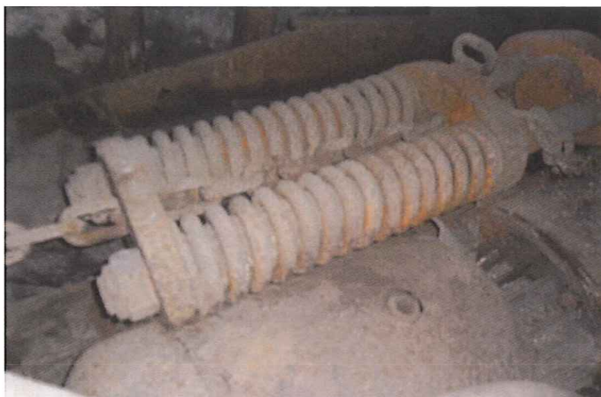
Napinak łańcucha kombajnowego na napędzie górnym.
