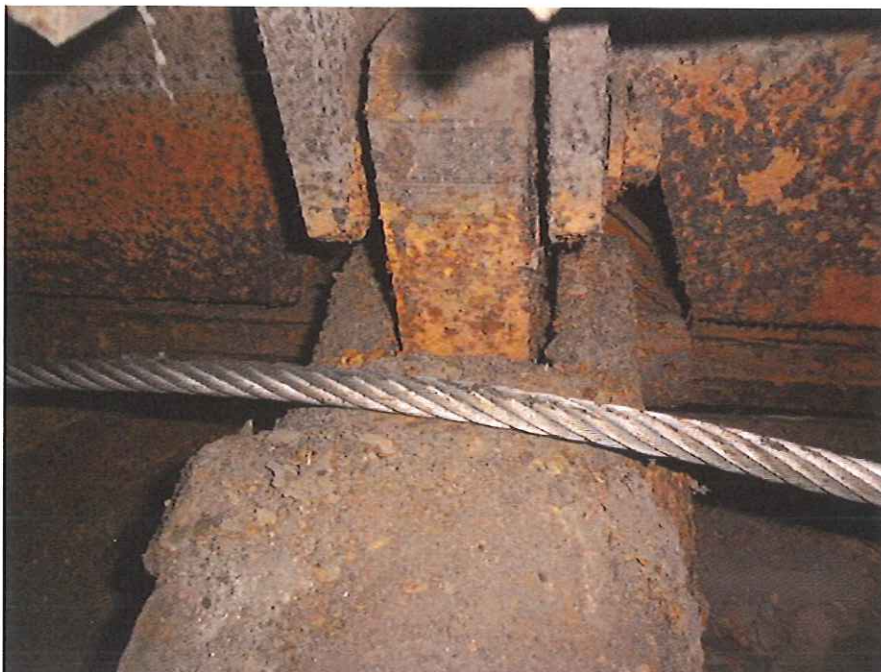
Widok sekcji zmechanizowanej obudowy osłonowej FAZOS-19/32-Oz z ręcznym sterowaniem przyległym (połączenie przesuwника z trasą przenośnika zgrzeblowego)
