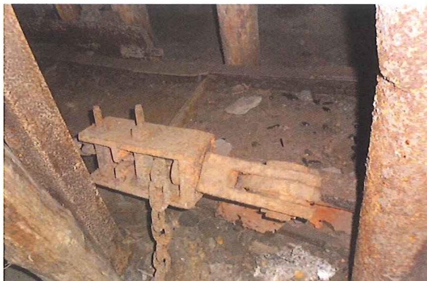
Napinak łańcucha kombajnowego na napędzie dolnym.
