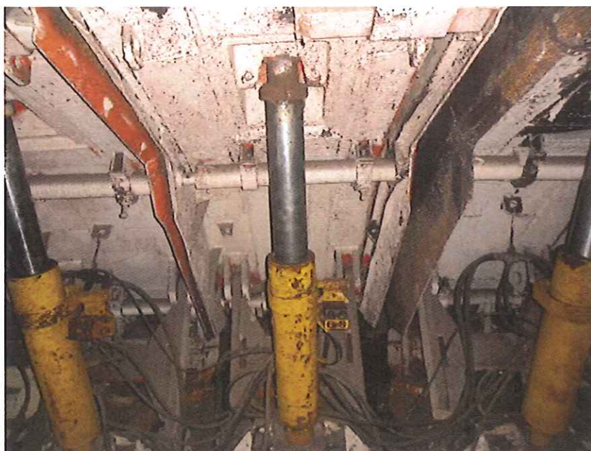
Widok sekcji zmechanizowanej obudowy osłonowej FAZOS-19/32-Oz z ręcznym sterowaniem przyległym (stożak hydrauliczny z przedłużaczem mechanicznym)
