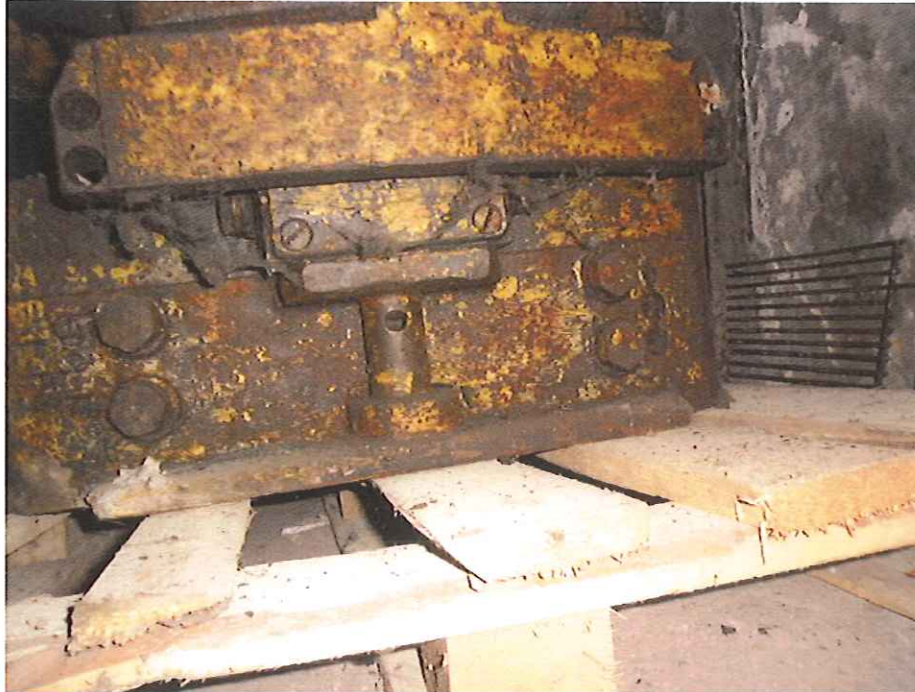
Widok przekładni głowicy od strony wrębnika.
