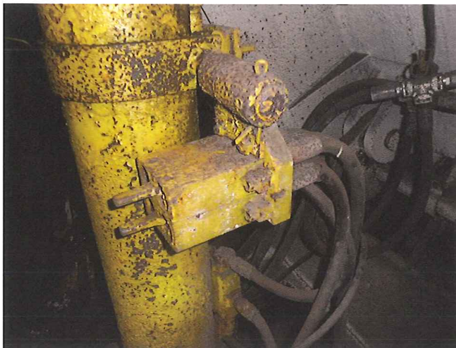
Widok sekcji zmechanizowanej obudowy osłonowej FAZOS-19/32-Oz z ręcznym sterowaniem przyległym (owężowanie, RB-2, BZ-1)
