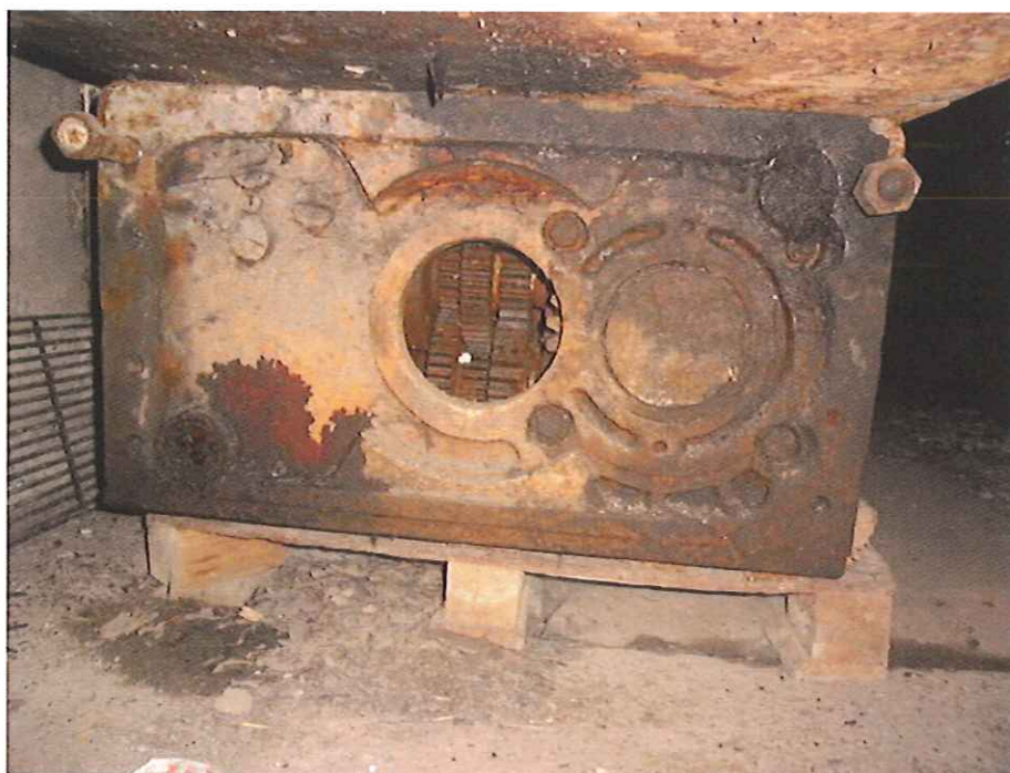
Widok przekładni głowicy od strony montażu silnika elektrycznego.
