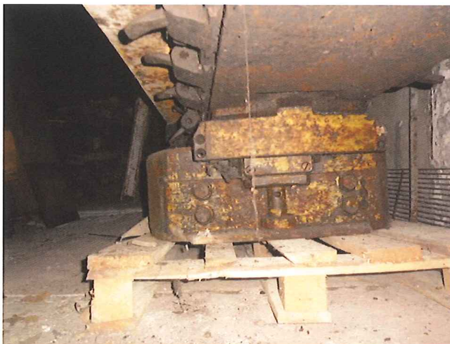
Widok przekładni głowicy z wrębniakiem.
