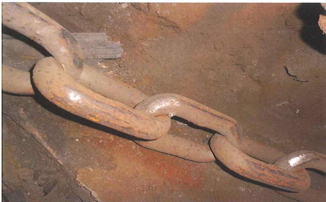
Łańcuch strugowy \varnothing 24 \times 86 struga SWS-4
