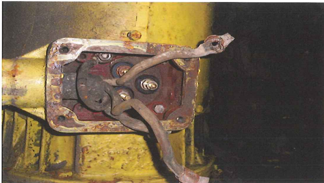
Widok skrzynki przyłączeniowej silnika napędu struga
