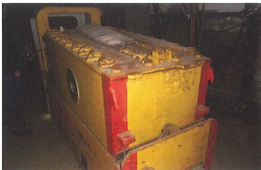
Lokomotywa dołowa Ldag-05 od strony baterii.
