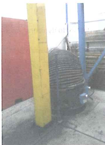
Wyprowadzenie lutni wentylacyjnej z przestrzeni szybu GUIDO
