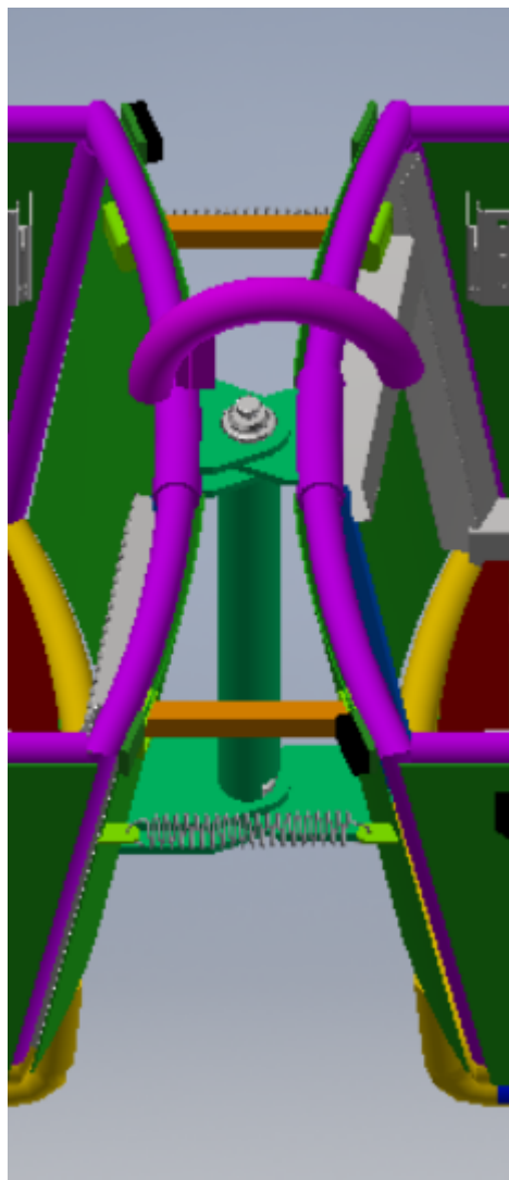
Rys. 4. Elementy stabilizujące połączenie łodzi A i B
