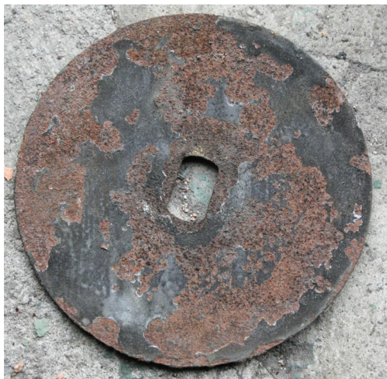
Fot.16 Przełącznik II wzoru, emaliowana tarcza wskaźnika pokrętła stan zachowania odwrocia
