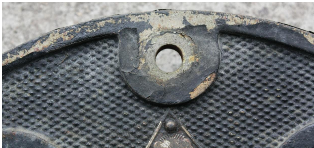
Fot.14 Przełącznik II wzoru- zachowane fragmenty powłok niklowanych
