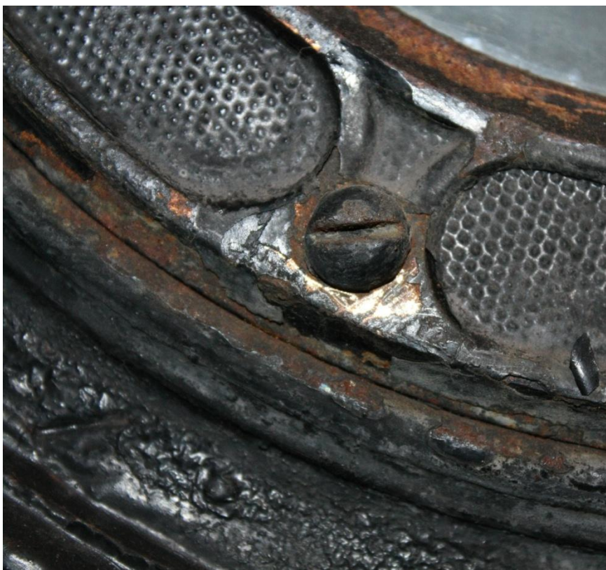
Fot.4 Zachowany fragment niklu na obudowie mirnika
