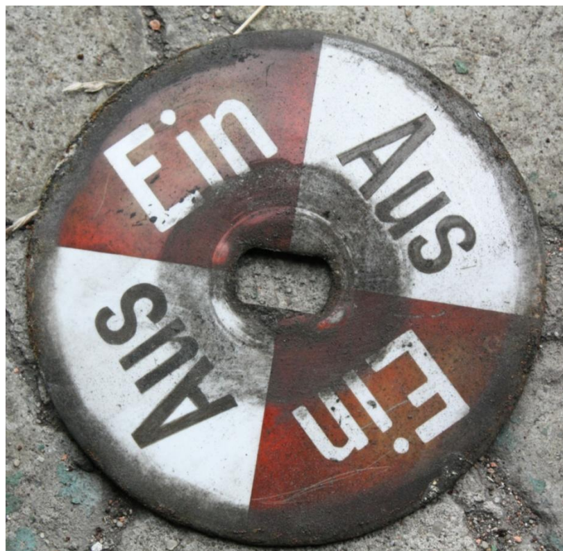
Fot.15 Przełącznik II wzoru, emaliowana tarcza wskaźnika pokrętła
