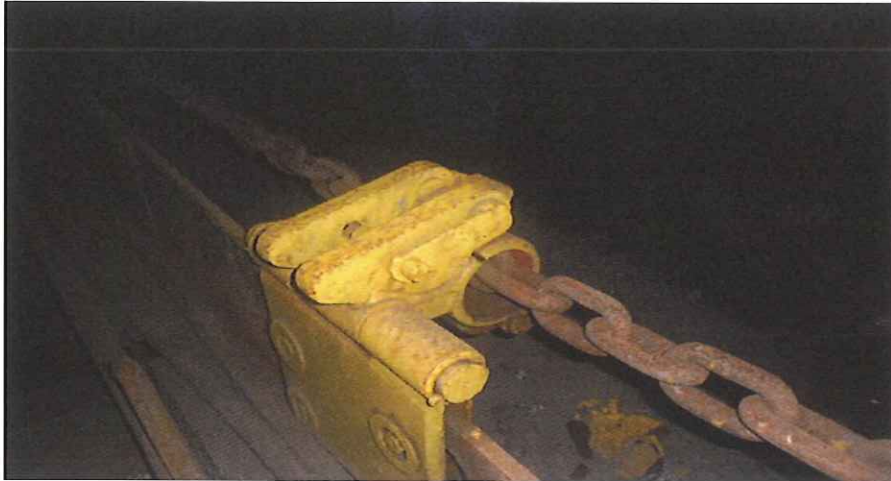
Urządzenie zabezpieczające przed „zabiczowaniem” łańcucha kombajnowego.
