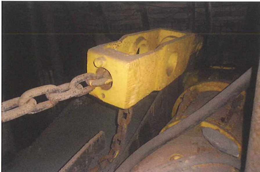
Łącznik przegubowy łańcucha kombajnowego.
