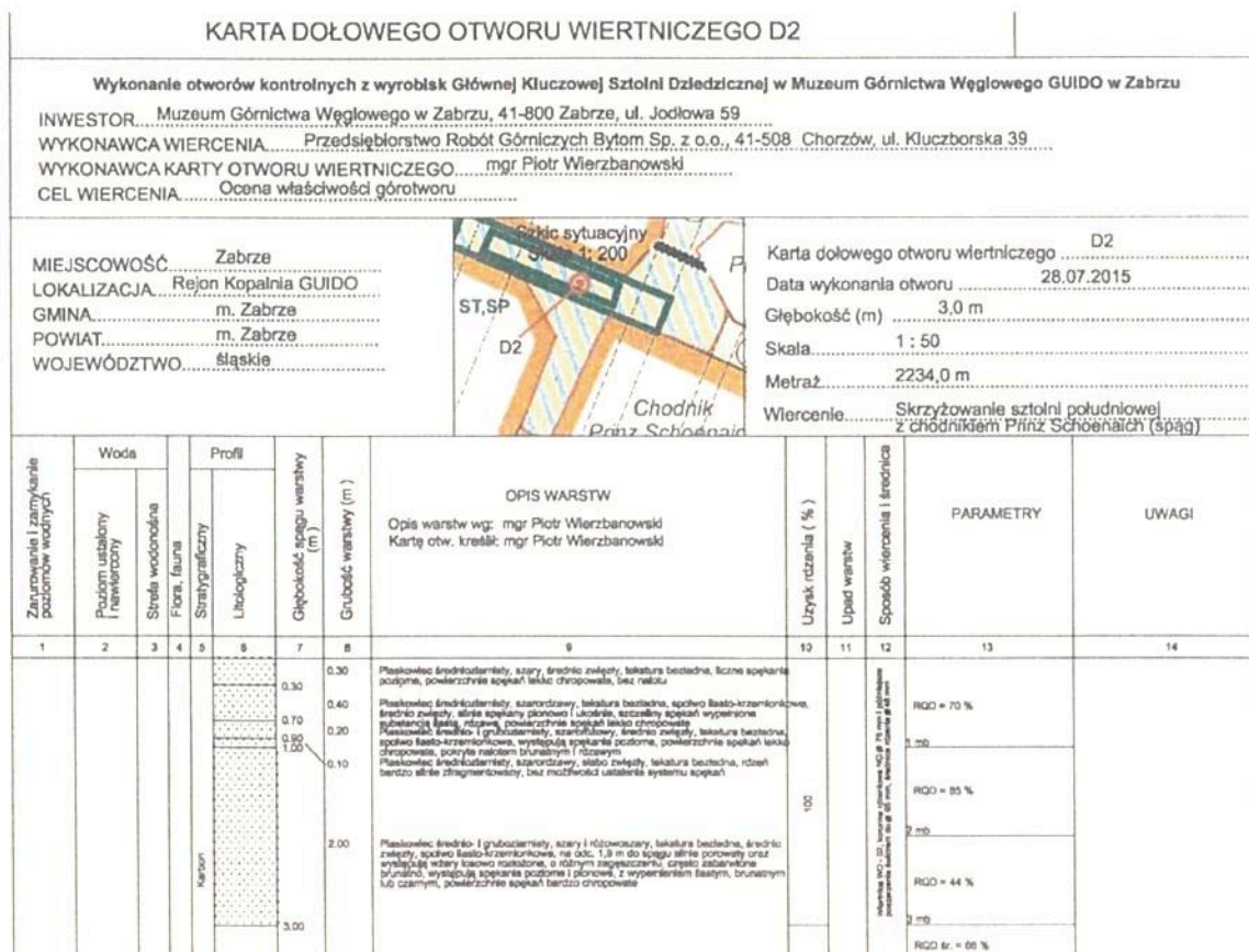
Rys.6. Profil litologiczny otworu D2 wykonanego w rejonie Chodnikiem Prinz Schoneaich – w spągu Sztolni południowej Głównej Kluczowej Sztolni Dziedzicznej.
